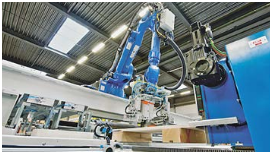
Der Roboterarm der neuen Kistenfabrikationsstrasse nagelt die Kistenteile in Rekordzeit zusammen.
